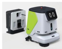
バッテリーが低下すると、ロボットは自動的に充電スポットへと帰還します。ワークステーションがあれば、充電だけではなく、給水・排水も自動的に完了します。
